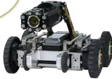
補助車輪ユニット iXA001A 搭載時
