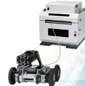
管内検査カメラシステム (ヘッド+自走車)
