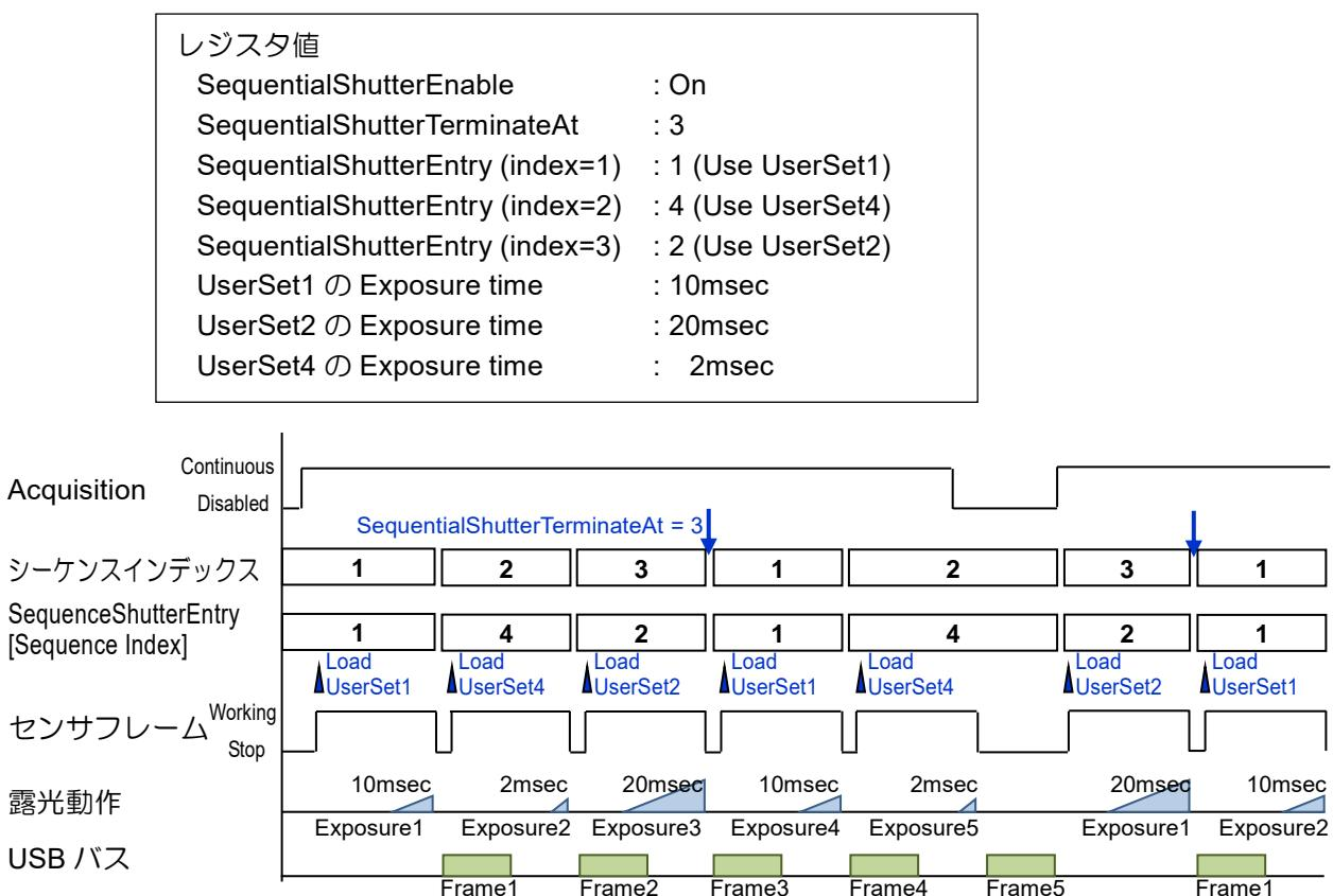
シーケンスインデックスは1から加算されますが、Aquisitionを停止状態にしても1にクリアされません。Aquisition停止中にSequenceShutterEnableレジスタを一旦ディスorghるにしてから再度イネーブルにすることによりシーケンスインデックスが1にクリアされます。
