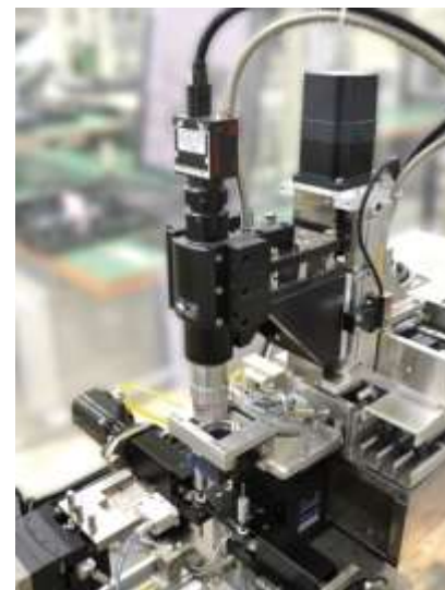
センサー位置調整設備
